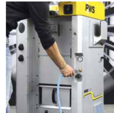
Anschluss für die Druckluftversorgung
