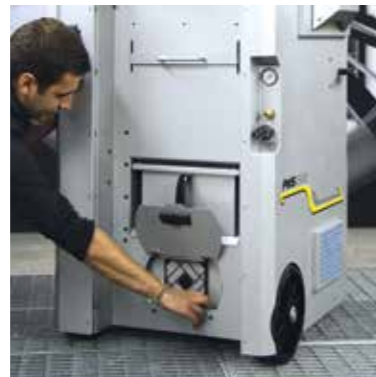
Wartungsklappe für die Filterreinigung der Turbine
